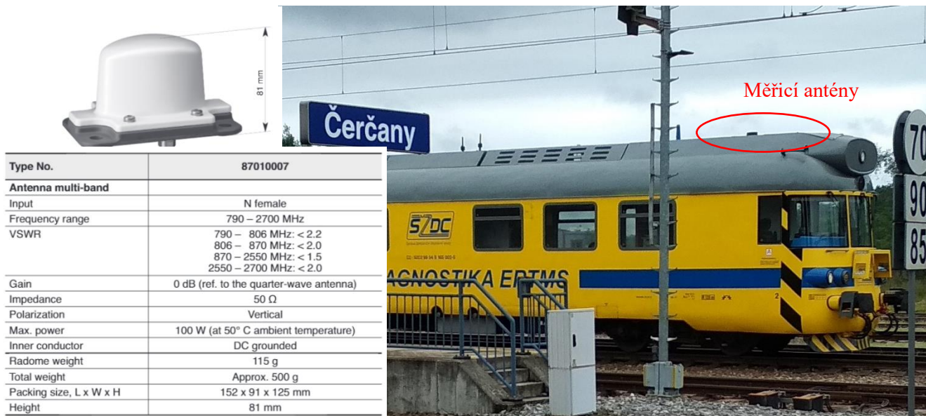
Obr. 2: Motorový měřicí vůz ERTMS s použitými anténami
