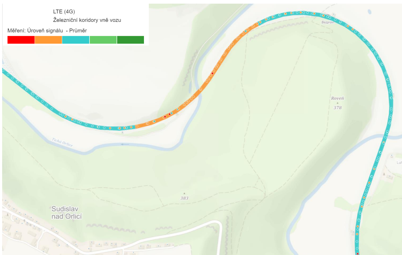
Obr. 6: Přiblížení úseku železničního koridoru 1 a 3, v blízkosti obce Sudislav nad Orlicí. Zřetelně viditelné úseky 250 m i měřené body a jejich proložení díky měření v obou směrech, zmiňované v textu.
