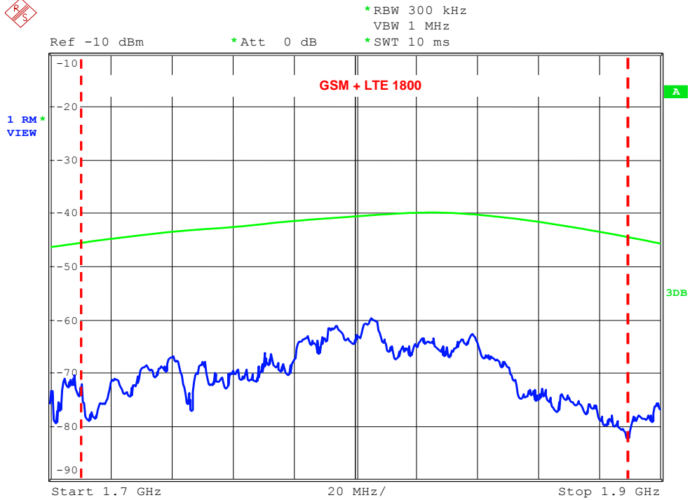
Naměřené hodnoty úrovní signálů v pásmu 1,7-1,9 GHz
